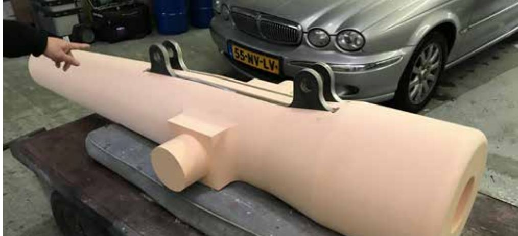
Het ruwe gietsel van de replica vuurmond, gemaakt van hardschuim. (NMM)
