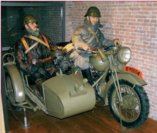
De BSA G14 hier tijdens betere tijden op de eerste etage van het Legermuseum, zomer 2006. Op de zijspanbak was een klem bevestigd om de mitrailleur M.20 veilig te kunnen vervoeren.
