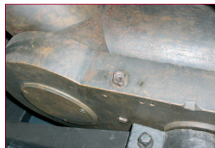
Detail van de afvuurinrichting: uiterst links de omhoog staande kamer en op de affuitarm de (verweerde) kruitpan.
