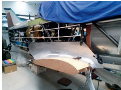
De overgang romp-ondervleugel rechts
