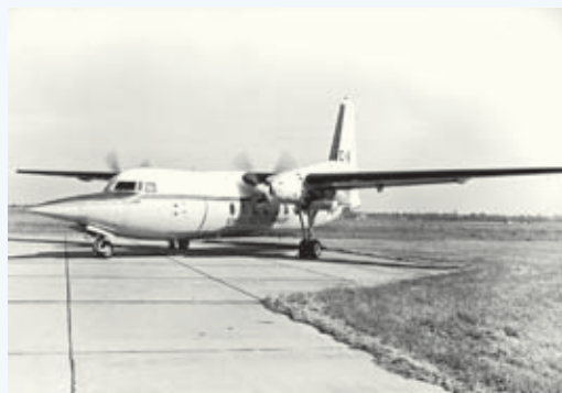
De Troopship C-8 wordt verbouwd en krijgt een Starfighterneus en de naam 'Flipper'
