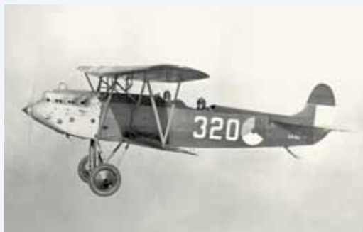
Een Fokker C.Vd nog met de oude HS motor. midden jaren dertig worden ze omgebouwd en voorzien van de Rolls Royce Kestrel motor
