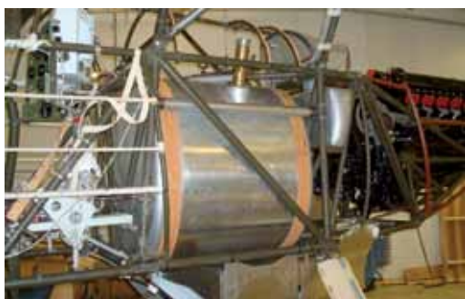
Benzinetank hangt op zijn plaats
