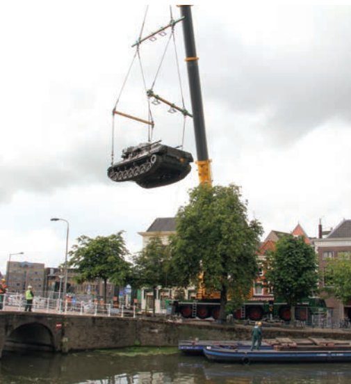
Hoog boven de straat zweeft het 40 ton zware rupsvoertuig richting dieplader.
