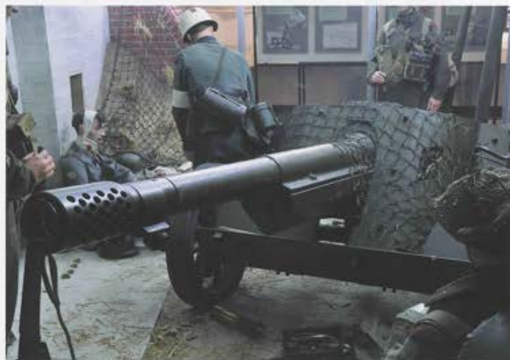
Afb. 12 De PAK 97/38 in de collectie van het Legermuseum. Dit wapen bestaat uit een Franse schietbuis model 1897 (met een nieuwe mondingsrem) op een Duits onderstel. Inv. nr. 005755
