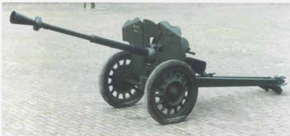
Afb. 4 Dit Franse Hotchkiss Anti-tankkanon model 1934, kaliber 25 x 193R heeft vermoedelijk, als 2,5 cm PAK 112 (f) onderdeel uitgemaakt van de bewapening van in Nederland gelegerde Duitse troepen. Het bewijs hiervoor is echter niet af te lezen aan het kanon, dat geen enkele modificatie kent dat daarop wijst. Inv. nr. 006648
