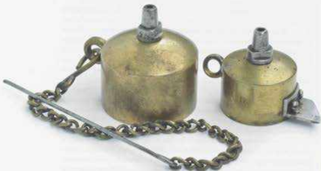
Afb. 2. Slagdoppen tot handgranaten. Nederlandse methode om handgranaten te ontsteken met behulp van een percussieslaghoedje (1854-1856). Aan het grotere exemplaar (inv. nr. 033791) is met een kettinkje een ruwmaald bevestigd om het schoorsteentje te reinigen. Het kleinere model (inv. nr. 032792) heeft een aangebouwd 'ontkapsmes', waarmee de afdekking van de handgranaatlont kon worden verwijderd.
