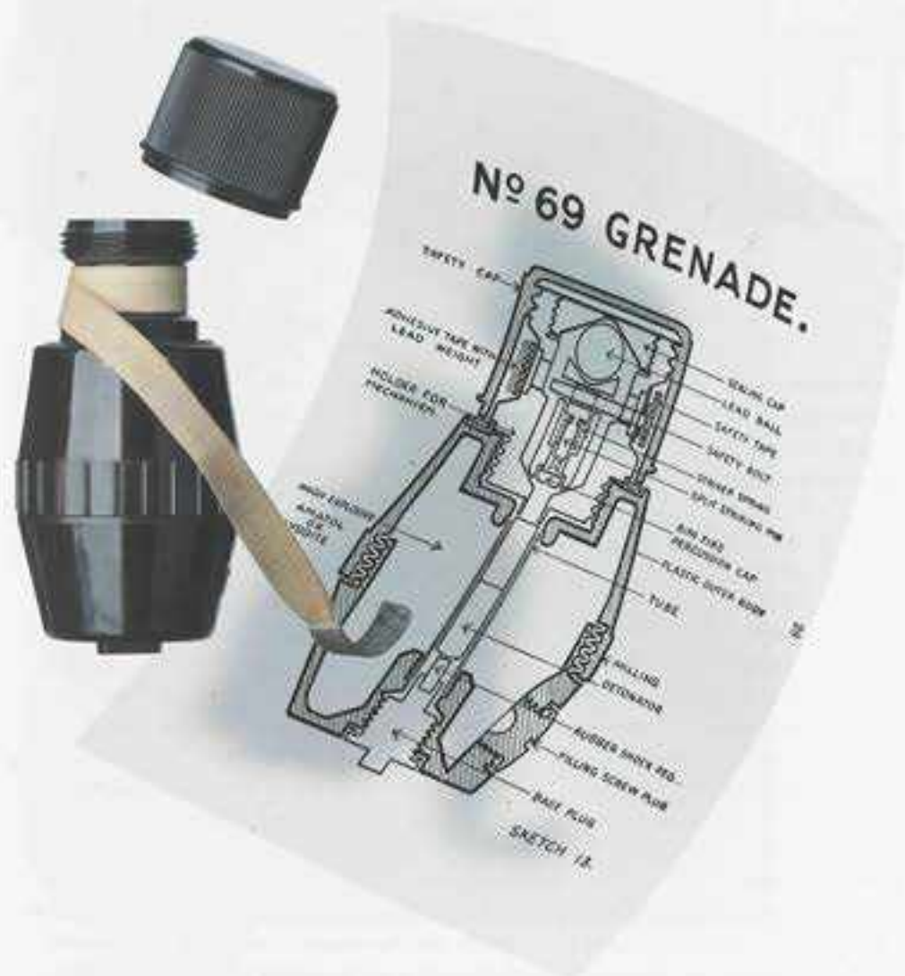
Afb. 9 Engelse (aanval-)schokhandgranaat N° 69 (inv. nr. 005391). Bakelieten granaatlichaam. Na het afschroeven van de beschermkap, houdt de werper met zijn wijsvinger het gewicht van de veiligheidsband vast. Tijdens de vlucht wikelt de band zich af en trekt de veiligheidspin uit. Bij het neerkomen zorgt de loden kogel voor het onsteken van het slaghoedje, waarna de granaat direct detoneert. Vervaardigd door de wereldbekende Londense drukkerij Thomas de la Rue van 1940 tot 1947.
