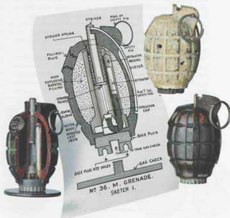
Afb. 7 - De Engelse Mills handgranaat N° 36. Links een opengewerkt model met drijfspiegel voor gebruik als geweergranaat (inv. nr. 005385), rechtsboven een onschadelijk werpgewicht voor oefeningen (inv. nr. 031958) en daaronder een normaal exemplaar (inv. nr. 035363). Op de achtergrond een doorsnedetekening uit het boekje Manual of Grenades van majoor J.J. Cowan. (1916 tot circa 1950).
