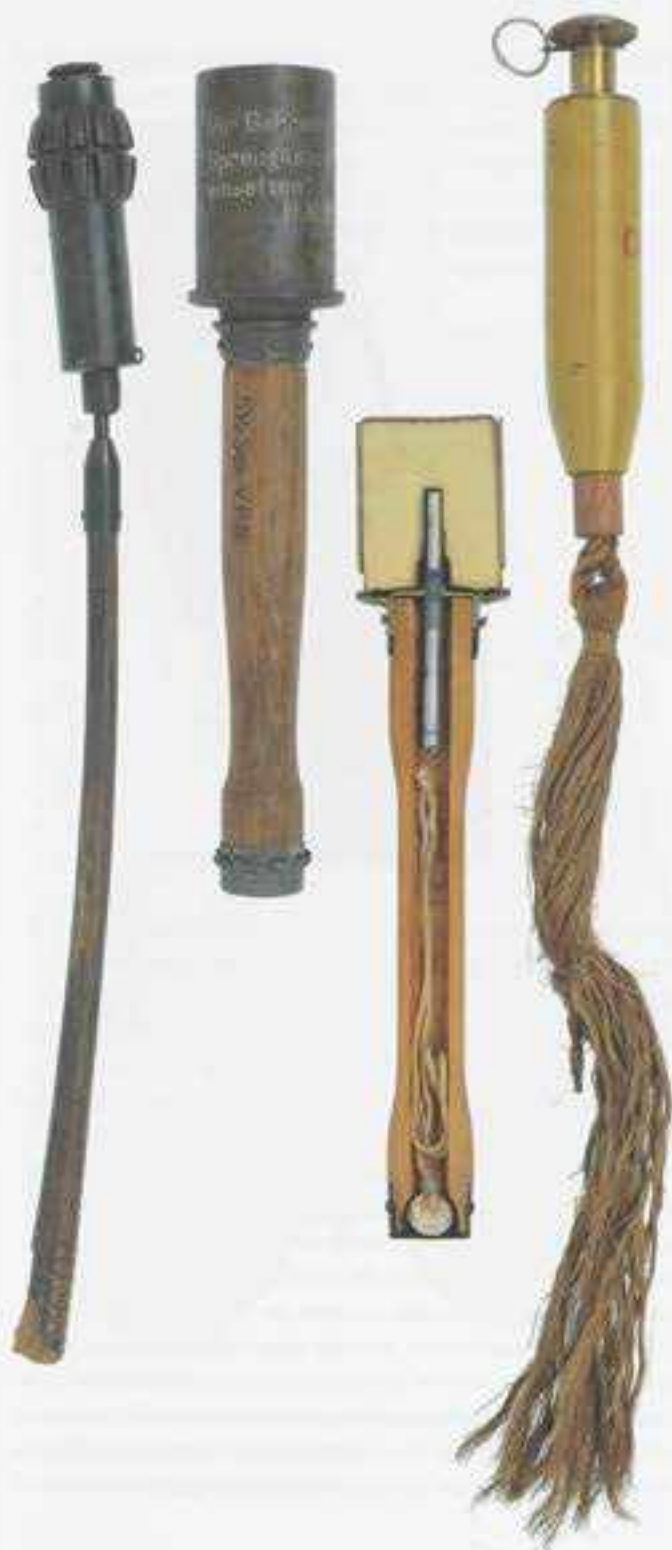
Afb. 3. Staal- en touwstaart-handgranaten v.l.n.r.: Engelse N°2 Mk1 (inv. nr. 035229), Duitse handgranaat, model 1917 (inv. nr. 031847), doorsnede van Duitse handgranaat, model (19)24, met voor de Waffen SS in 1943 ontwikkelde splintemantel (inv. nr. 023493), Nederlandse schokhandgranaat (inv. nr. 005249), eerste helft 20 e eeuw.
