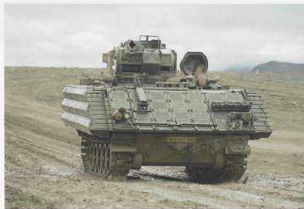
Afb. 9 Testrit in Uzuzgan met een YPR waarop ERA pantsering is aangebracht. (Defensie Materieelorganisatie)
