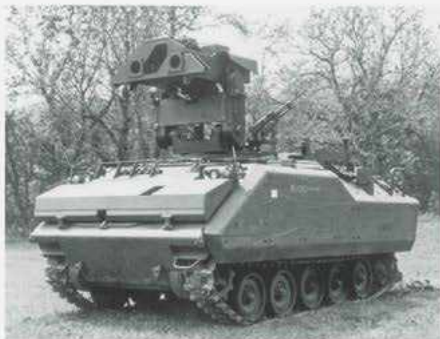
Afb. 7 YPR PRAT (Pantser Rups Anti Tank). De PRAT kon met draadgeleide antitankraketten tot circa vier kilometer doelen uitschakelen. (Collectie W. den Dunnen)
