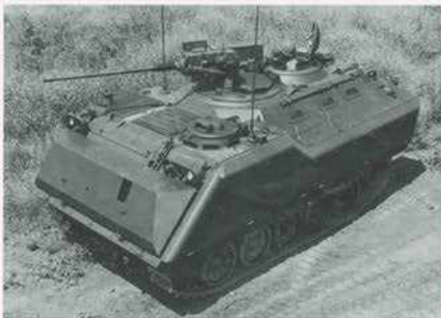
Afb. 4 De XM 765 (X staat voor experimenteel), de voorloper van de YPR. Hij heeft al veel kenmerken van de YPR, maar de koepel is hier bijvoorbeeld nog in het midden geplaatst. (Legerkoerier oktober 1977)
