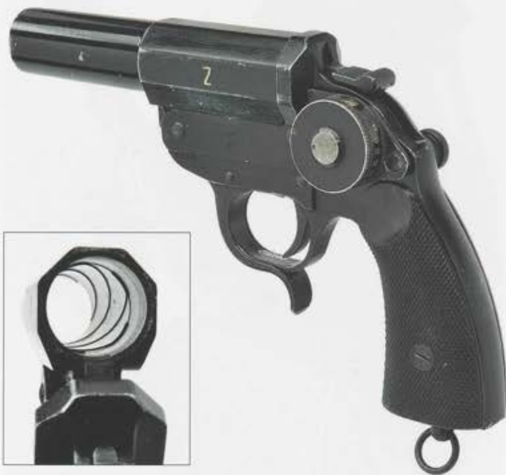
Afb. 9 Getrokken lichtpistool "Z", ook wel "Kampfpistole" genoemd (inv. nr. 002917). Dit exemplaar is van lichtmetaal en werd in 1941 vervaardigd bij de Erfurter Maschinenfabrik B. Geipel (ERMA-Erfurt). Met dit wapen konden alle Duitse licht- en seinpatronen worden afgevuurd, maar ook de vooraf van trekken en velden voorziene gevechtsmunitie. Het opschroefbare waterpasje deed dienst als richthulp en is tegenwoordig uiterst zeldzaam.
