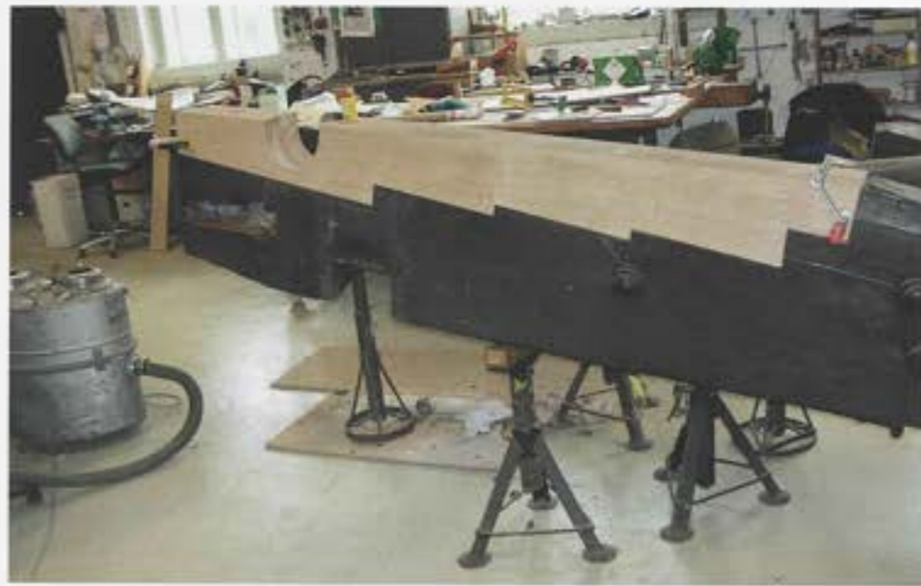
Afb.14 Met name de wangen bleken aangetast en grote delen moesten worden vervangen. In totaal heeft de restauratie 2500 manuren gekost. (Foto B. Berkel)
