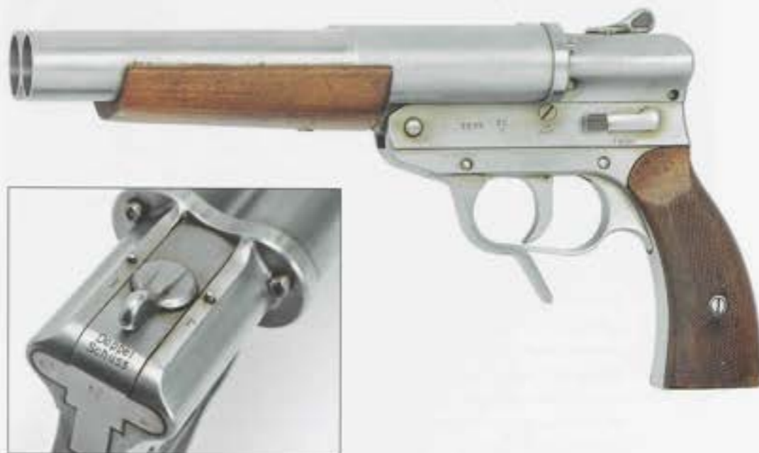
Afb. 6 Roestvrijstalen dubbelloops seinpistool van de 'Kriegsmarine', model SLD (inv. nr. 004913). Vervaardigd bij Carl Walther in 1941 en bestemd voor gebruik aan boord van onderzeeboten. Met behulp van de schakelknop konden naar believen de linker, de rechter of beide lopen tegelijk worden afgevuurd.
