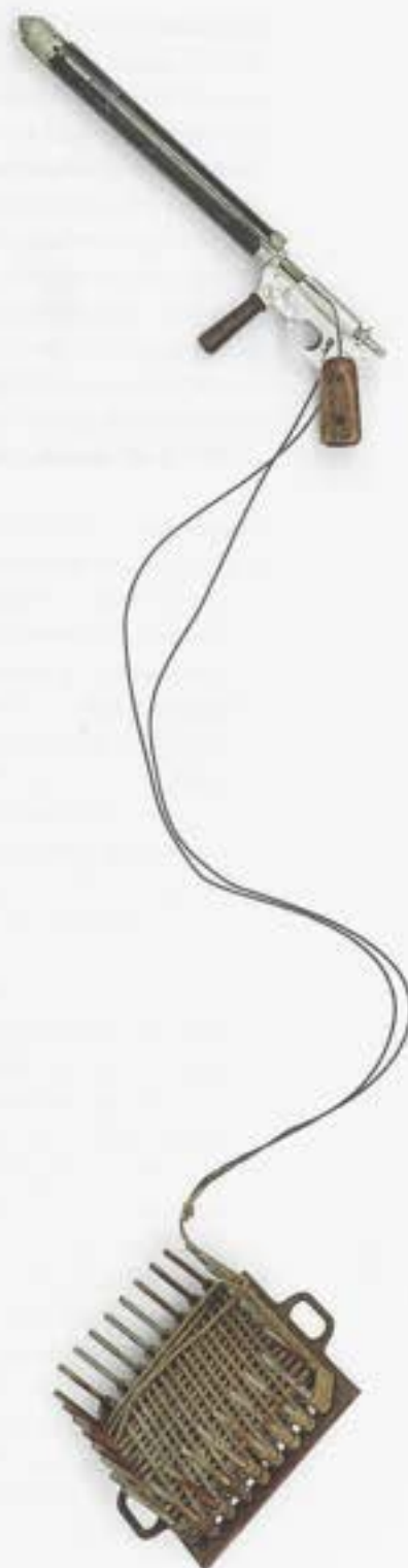
Afb. 14 Het 'Sander Leinenpistole' (inv. nr. 000431) van de Kriegsmarine met rakethouder (de sigaarvormige koker met de kabelbeugels werd geladen met een losse raketpatroon) en de touwhaspel (inv. nr. 101185).
