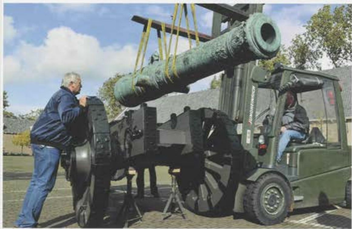
Afb. 20 Na de restauratie vindt het huwelijk tussen de loop en het affuit plaats. Het kanon kan weer compleet met onderstel worden tentoongesteld in St. Petersburg. Loop en affuit wegen samen in totaal 5420 kg. Links de houtrestaurator B. Berkel.
