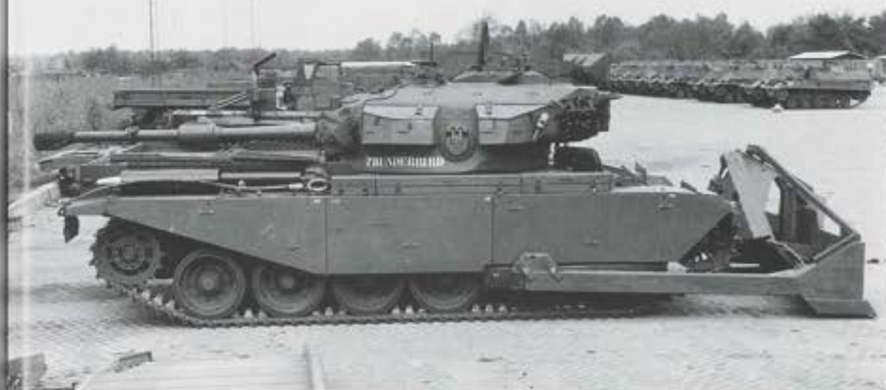
Afb. 9 Een Centurion Mk 5 dozertank met een 20 pondere kanon ('8-barrel') en stalen tracks. Op de voorgrond is nog net een uiteinde van een Centurion schaarbrug te zien. (Foto LFFD, collectie IMG)
