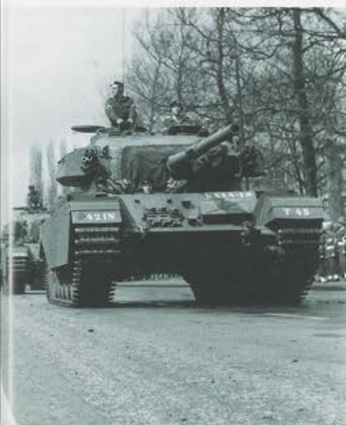
Afb. 3 Twee Centurions Mk 5 van 42 Eskadron Zware Tanks, beide met een 20 ponder kanon, links met een 'A-barrel' en rechts met een 'B-barrel' voorzien van een contragewicht in plaats van de rookafzuiger en beide met stalen tracks. De tanks nemen deel aan de parade op Koninginnedag 1956 in Enschede. (Foto Leger Film- en Fotodienst(LFFD))
