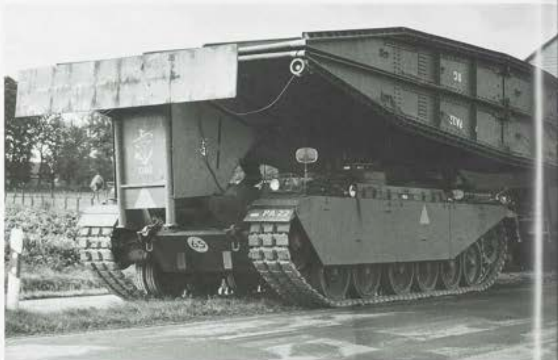
Afb. 8 De voorzijde van een Centurion Mk 5 bruggenlegger van 11 Pantsergeniecompagnie tijdens een oefening in Duitsland. De brug bevindt zich dubbelgevouwen in transporttoestand. De dwarsbalk is het stempel dat bij het uitvouwen tussen de tank en de brug op de grond komt te rusten. (Foto waarschijnlijk LFFD, collectie auteur)
