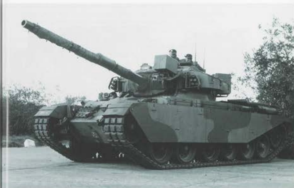
Afb. 11 Een Centurion Mk 5/2 met een 105 mm kanon, tracks met rubberblokken en een Xenon-zoeklicht. (Foto LFFD, collectie IMG)
