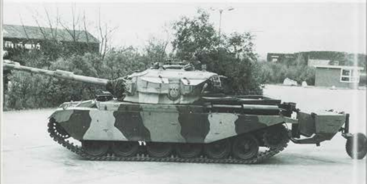
Afb. 6 Een in vlekkenpatroon gecamoufleerde Centurion Mk 5/2 van 101 Tankbataljon op de parkeerplaats van dat bataljon naast de 574 Tankwerkplaats in Leusden. De tank is voorzien van een 105 mm kanon, tracks met rubberblokken en een gekoppelde montrailer. (Foto LFFD, collectie W. den Dunnen)
